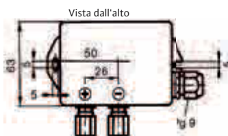
da DDG 10 a DDG 100 (DDG 2 senza fig.) (Le misure sono in mm), Accessori di fissaggio a cura del committente
